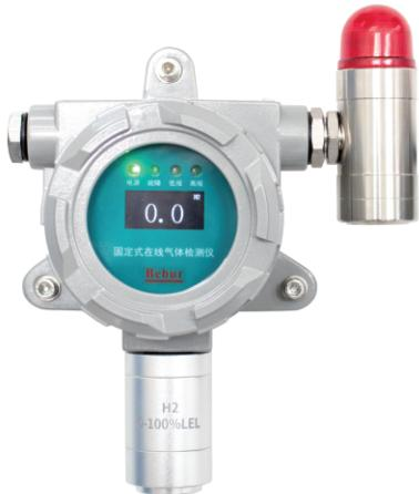
AS-300是一款可以连续在线检测环境空气中可燃气体浓度的固定式气体检测仪。仪表采用催化燃烧原理，可将现场检测到的实时气体数据通过4-20mA信号或RS485信号进行传输,是一款现场LCD显示、传感器更换即插即用的标准三线制可燃气体检测仪，满足不同行业的应用需求。
